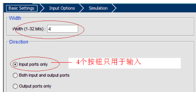
图 11-43 按钮的位宽和输入输出选择的设置
