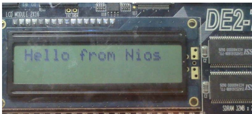
图 6-20 DE2-70 实验板 LCD 上显示：Hello from Nios
