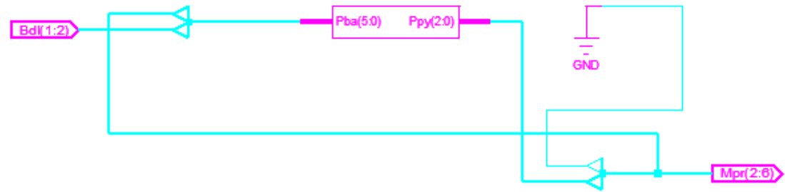
图 3-4 例 3-4 综合后的 RTL 级结构示意图
