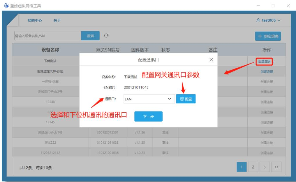
其中，【配置】界面为网关通讯口参数，如【通讯口】选择“LAN”，则弹出界面为 LAN 口参数。建议选择【手动设置 IP】，IP 地址填写与下位机同一网段的任意一个 IP 地址，子网掩码默认为 255.255.255.0。
