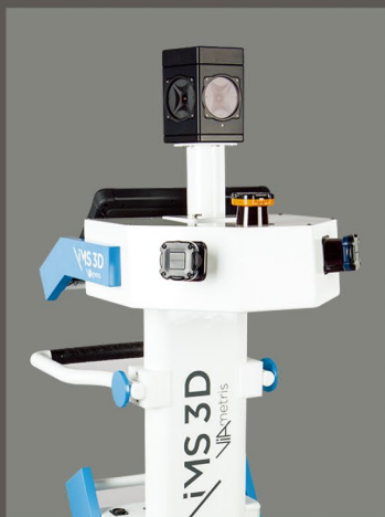
捕获设备包括3个激光解析仪 和一个全景照相机
